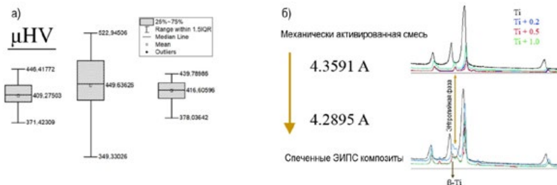
Рисунок 1. (а) Дисперсия значений твердости. (б) Фазовые изменения в процессе ЭИПС
