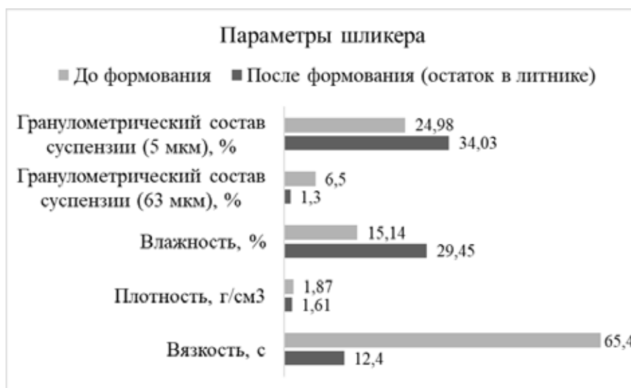
Рисунок 1. Параметры шликера до и после электрофоретического формования
