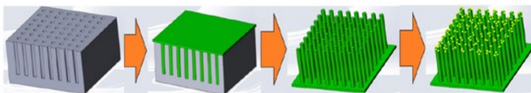
Рисунок 1. Принципиальная схема получения никелево-палладиевого катализатора
